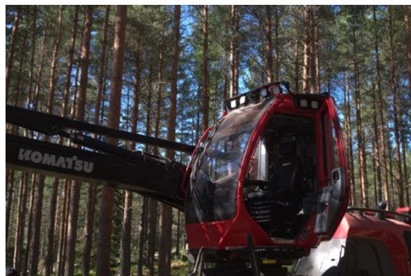
写真-3 NFA の間伐密度推定システム キャビン上部の 3D-LiDAR により周囲の立木を把握する。
