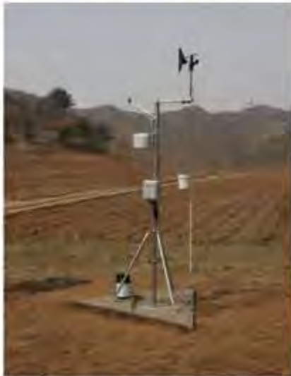
조선국가과학원 식물학연구소 상원시험장에 설치된 자동기상 관측장비 ( meteorological instruments ) (2009년에 지원)
