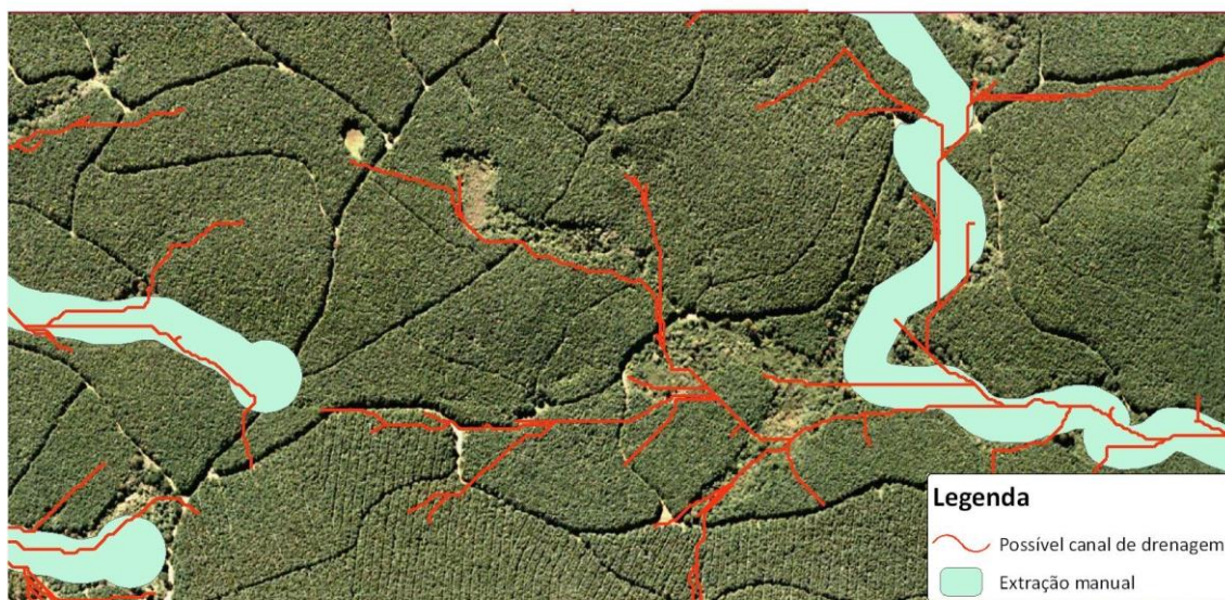
Figura 4. Possíveis canais de drenagem.
