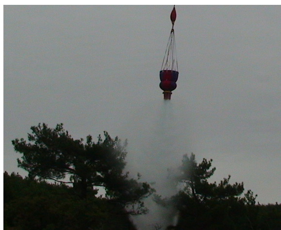
Рис. 5. Эффект "пробивания" кроны сосняков струей рабочей жидкости из ВСУ-5А
