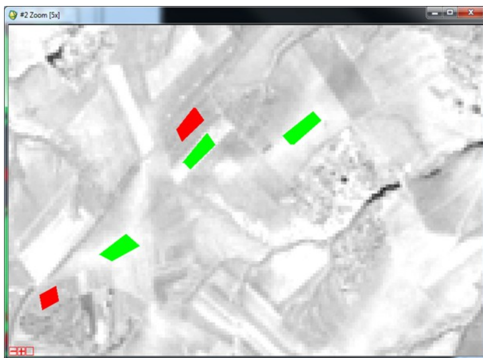
Рис. 1. Пример ROI на снимке Landsat, использованных при классификации (красный цвет – участки зарастания, зеленый – участки, оставшиеся неизменными)
