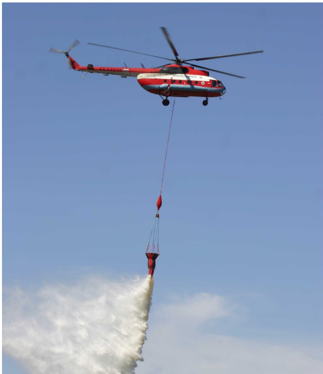
Рис. 3. Вертолет Ми-8Т с ВСУ-5А и системой СДП-1
